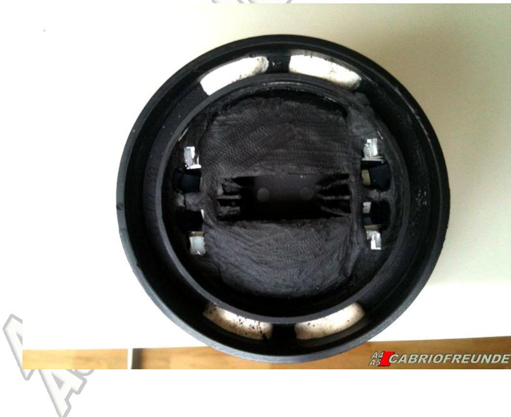
Nun nehmen wir uns unseren Originaldeckel vor, von dem das Oberteil von allen 4 Seiten gleichmäßig mit der Trennscheibe entfernt werden muss. In der Mitte sollte man aber noch einen eckigen Steg stehenlassen. Dieser hält einerseits den Messstab und greift andererseits in die Vertiefung des R8 Deckels. Dadurch verkanten sich beide Teile später und die Konstruktion wird am Ende nicht nur vom Klebstoff gehalten. Schließlich entstehen beim auf- oder zudrehen doch gewisse Kräfte.
