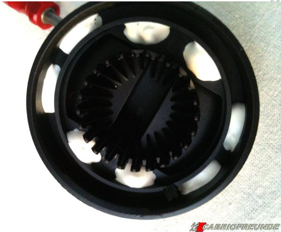
Dieser muss nun regelrecht "entkernt" werden - hierbei hilft der Dremel mit einem Fräsaufsatz. Es macht dabei auch nichts wenn die weiße innere Befestigung des Alus (dicke, harte, weiße Knubbel) praktisch komplett entfernt wird. Das Aluteil hat noch eine äußere Befestigung und die hält es mühelos alleine. Aufpassen muss man nur, dass man den Kunststoff nicht zu dünnwandig werden lässt - schließlich will man da ja später außen mal anfassen.
