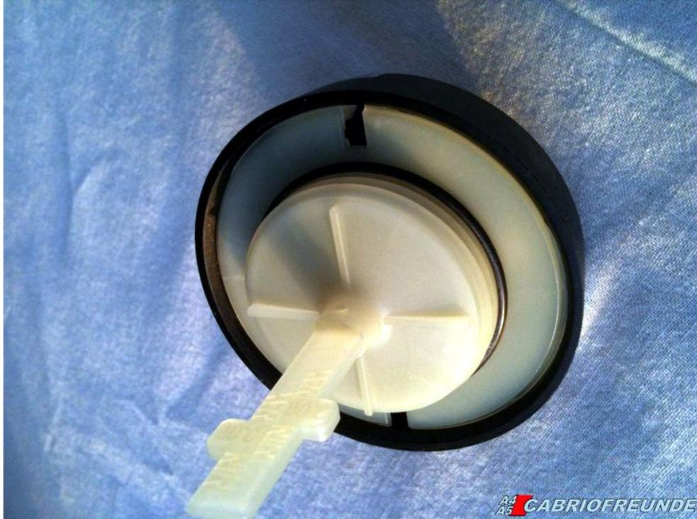
Wir müssen also aus zwei Deckeln einen machen und fangen damit an, mit Hilfe einer Trennscheibe das Gewinde des R8 Deckels zu entfernen (Gummidichtung vorher entfernen). Dazu setzen wir die Trennscheibe unmittelbar unterhalb des weißen Ringes an. Dieser ist in den Außendeckel nur geclipst und fällt uns schon fast entgegen wenn das Gewinde ab ist.
